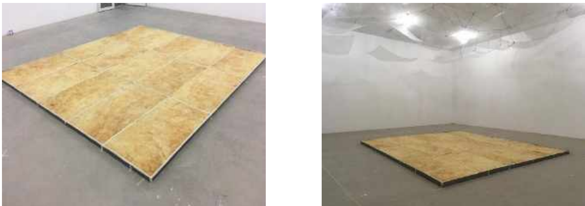
Figura 2 – Câmara reverberante de absorção com amostra considerada padrão de lã de vidro, com as medidas de 2,50x3,60m
