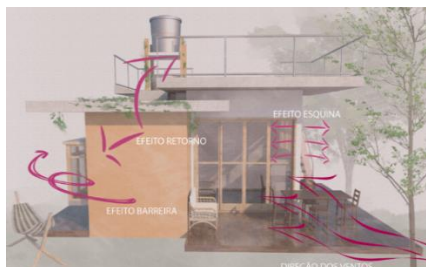
Figura 11 – Efeitos aerodinâmicos percebidos no ensaio no túnel de vento para o projeto AquaDomus .
