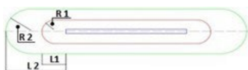
Figura 4 - Esquema das distâncias para o traçado das curvas C-1 e C-2. Fonte: Adaptado do DAC, 1987.
