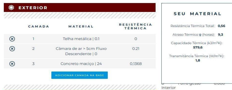
Figura 16 - Resultado das propriedades térmicas da cobertura do bloco 2 - CAD 2 (Fonte: ProjetEEE, 2023).
