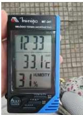
Figura 8 Aparelho utilizado na medição: Minipa MT-241, dados correspondem ao 20º ponto medido. Fonte: ACERVO PESSOAL, 2018.
