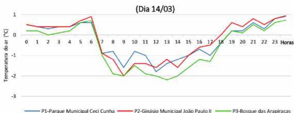
Figura 7 – Variação da temperatura do ar nos pontos 1, 2 e 3 em relação à estação meteorológica automática do INMET (dia 14/03)
