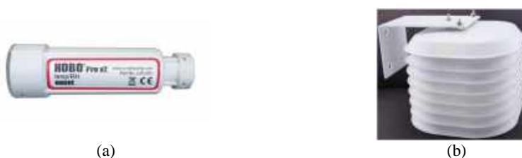
Figura 1 – Equipamento para medição de variáveis climáticas e escudo de proteção da radiação direta.
