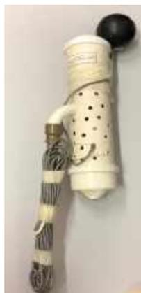
Figura 4 - Sensor HOBOTerm U12-012 com cabo externo TMC20-HB, em abrigo móvel vertical, sendo um modelo adaptativo, construído com Tubo de PVC.
