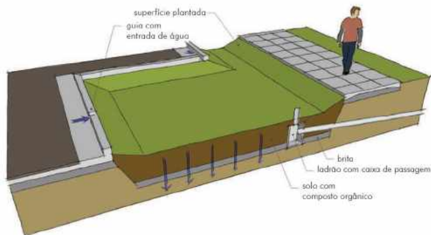
Figura 3 – Esquema de jardim de chuva. Fonte: Cormier e Pellegrino (2008).
