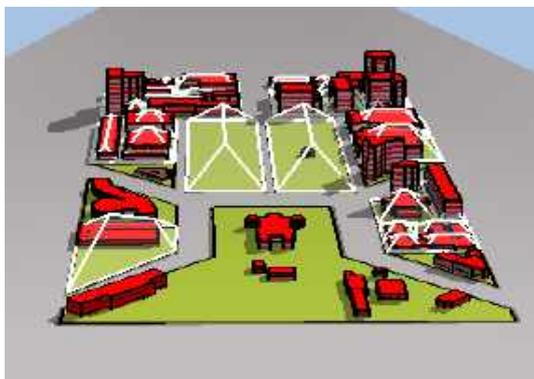
Figura 3- Envelopes solares gerados às 9 horas na Praça da Liberdade em Belo Horizonte, MG, através do software Cityzoom® (VILELA *et al.*, 2010)
