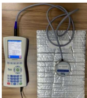
Figura 7 - Equipamento ISOMET 2114, marca Applied Precision
