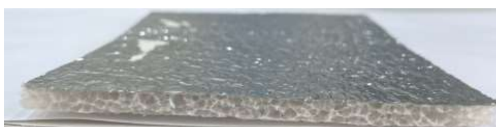
Figura 6 - Vista lateral da manta aluminizada uma face com isolamento em poliuretano
