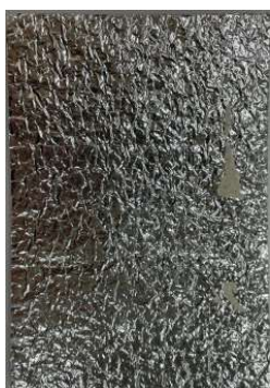
Figura 5 - Vista frontal da manta aluminizada uma face com isolamento em poliuretano
