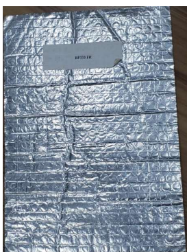
Figura 3 - Vista frontal da manta aluminizada dupla face com recheio em plástico bolha
