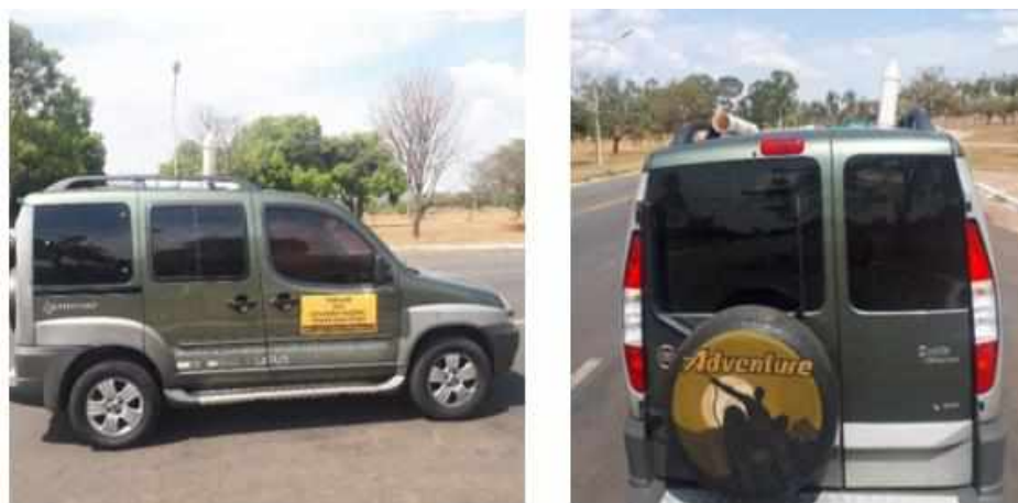
Figura 05 – Conjuntos (abrigos meteorológicos + registradores) instalados no automóvel do Lasus – UnB (altura de instalação = 2,0 metros).
