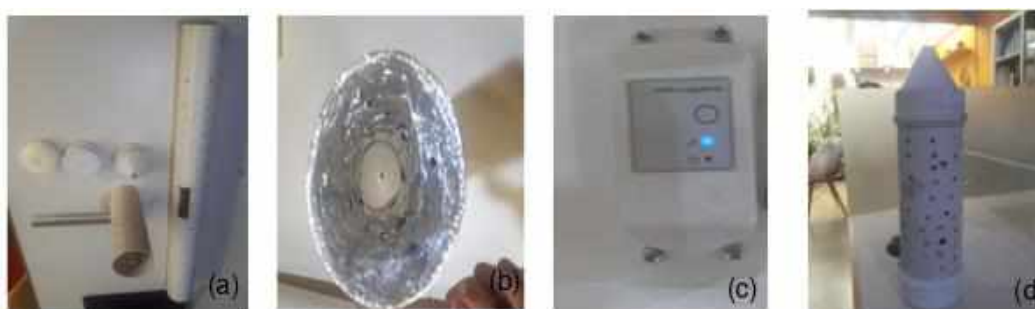
Figura 04 – Construção dos abrigos meteorológicos vertical e horizontal: (a) tubulação de PVC perfurada, (b) instalação de camada de isolamento, (c) registrador de temperatura do ar/umidade relativa do ar HOBO MX2310 e (d) abrigo meteorológico montado (vertical).
