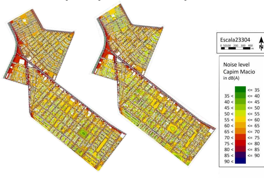
Figura 3 – Mapa de ruído para o bairro de Capim Macio nos períodos matutino (7h-8h, à esquerda) e vespertino (17h-18h, à direita). Fonte: Elaboração dos autores, a partir dos dados de Florêncio (2018).
