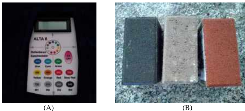
Figura 2 – Espectrômetro portátil Alta II (A) e amostras submetidas ao ensaio de refletância (B). (AUTORES, 2019).
