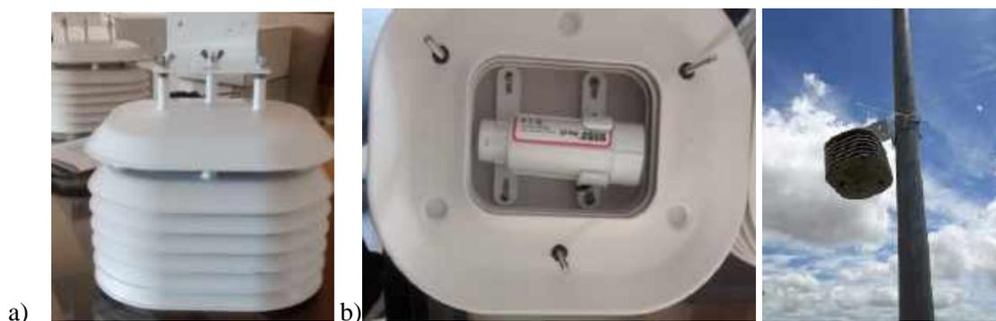
Figura 1: a) Equipamento de proteção do HOBO Pro v2 *data-logger* (U23-001); b) HOBO posicionado no dispositivo de proteção e, c) equipamento instalado no poste. Fonte: Os autores (2019)
