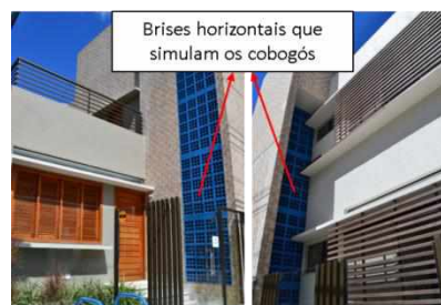
Figura 14 – Brises horizontais modeladas no EnergyPlus que simulam os cobogós.
