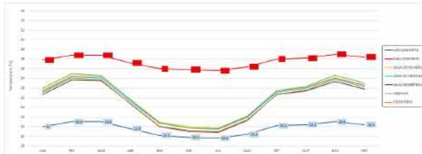
Figura 17 – Temperatura operativa média de cada zona ao longo do ano para a simulação #4.
