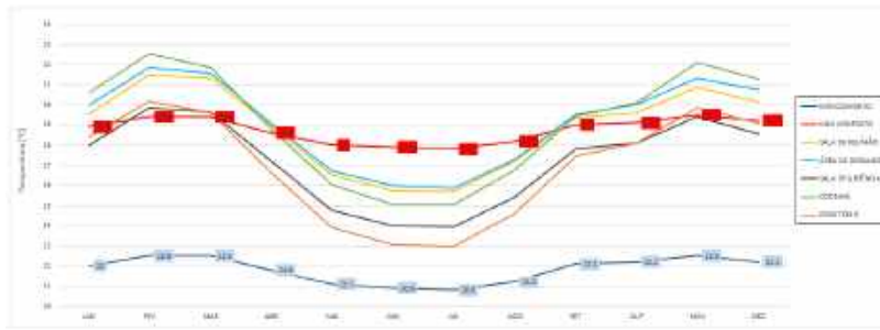
Figura 15 – Temperatura operativa média de cada zona ao longo do ano para a simulação #3.
