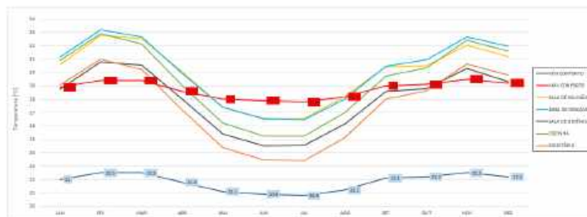
Figura 9 – Temperatura operativa média de cada zona ao longo do ano para a simulação #1.
