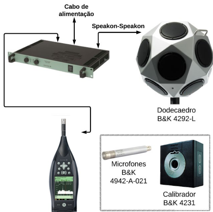
Figura 1 – Cadeia de medição adotada nas medições in situ .
