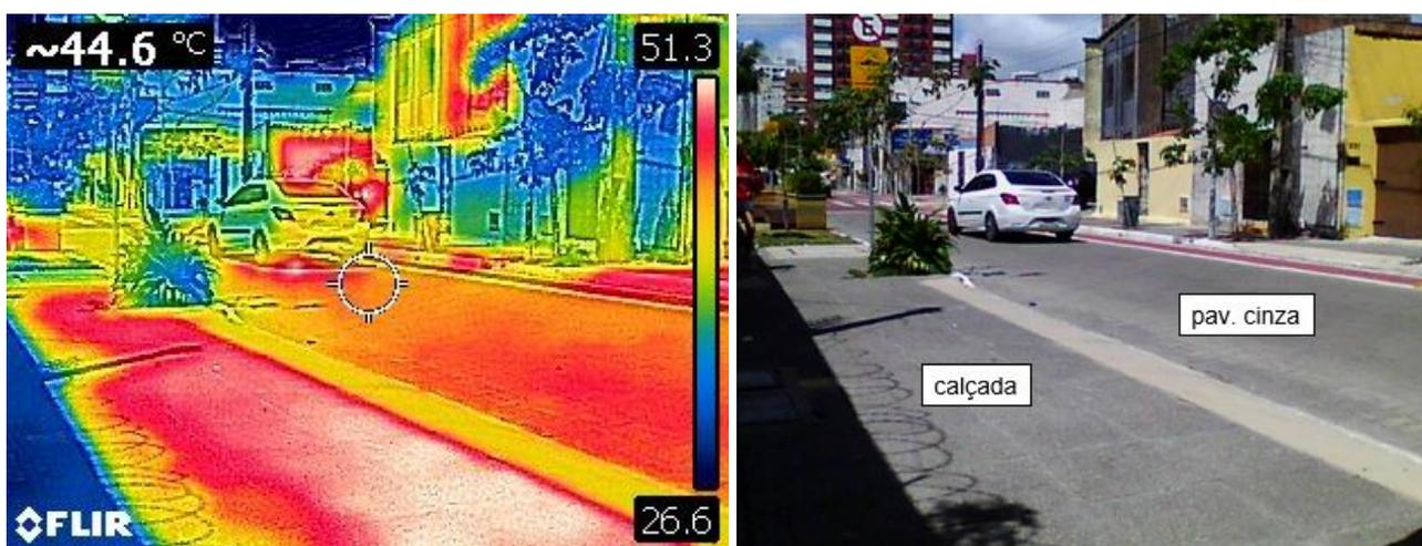
Figura 9 – Imagem térmica de superfície do pavimento poroso e pavimento intertravado às 10 hs.
