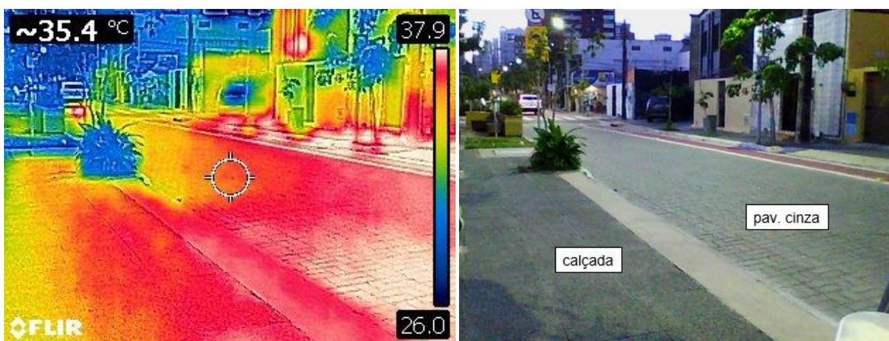
Figura 10 – Imagem térmica de superfície do pavimento poroso e pavimento intertravado às 17:50 hs.
