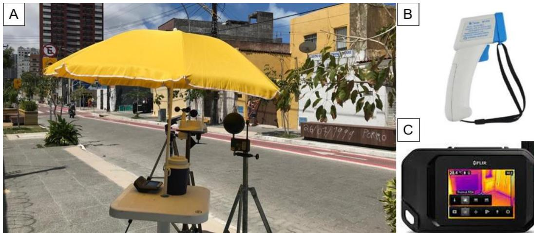
Figura 5 – (a) Posição da estação meteorológica durante a medição; (b) Câmera térmica e (c) Termômetro pistola de medição.
