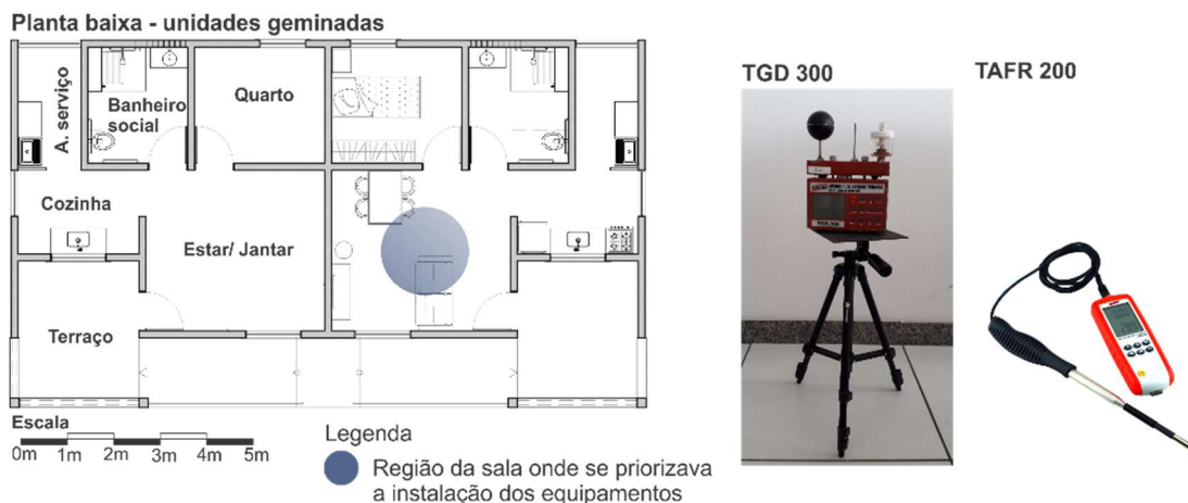
Figura 3 - localização de instalação dos equipamentos durante as medições nas casas, adaptado de CEHAP (2021).
