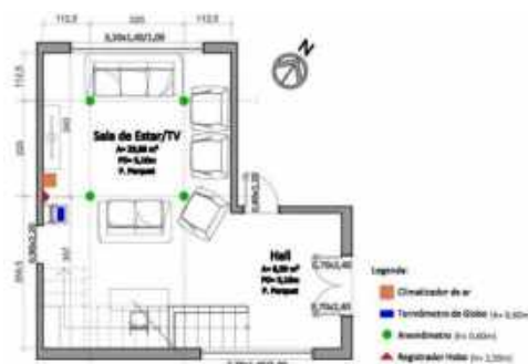
Figura 6 – Planta baixa Sala de Estar C do Longevità: posicionamento dos instrumentos de medição e equipamentos.
