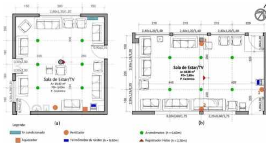
Figura 5 – Planta baixa Sala de Estar A (a) e B (b) do Lar: posicionamento dos instrumentos de medição e equipamentos.
