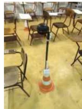
Figura 4 – Medidores do tipo HOBO.
