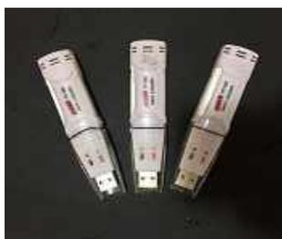
Figura 3 – Medidores do tipo HOBO.
