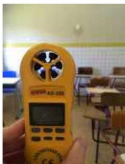
Figura 5 – Anemômetro digital
