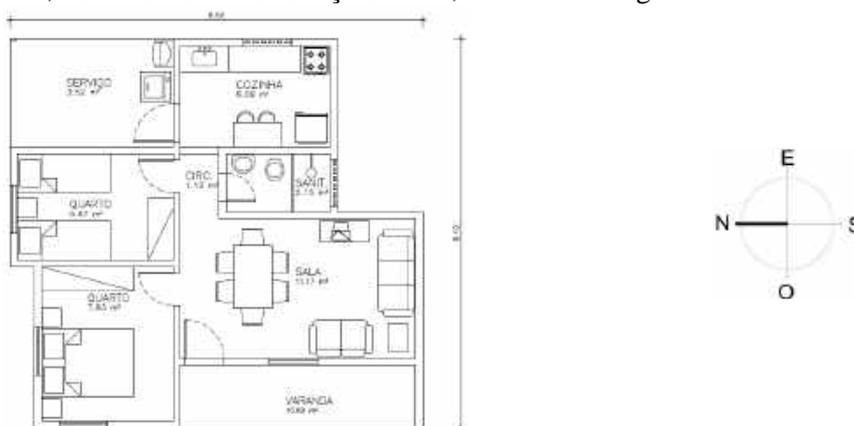
Figura 2. Planta baixa edificação. Fonte. Adotado de Estudiofaro1.
