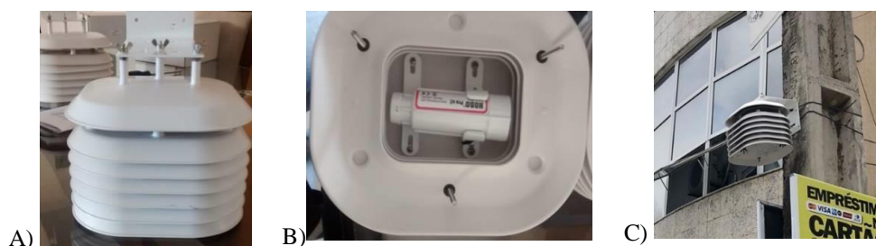
Figura 4- Imagem do equipamento utilizado para o monitoramento microclimático em Arapiraca: A) Dispositivo de proteção do sensor; B) Posicionamento do Hobbo ProV2 no interior do dispositivo e proteção e C) Equipamento instalado em poste de iluminação pública. Fonte: Os autores (2022)
