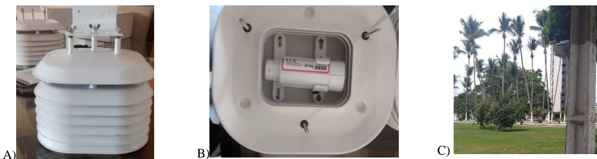
Figura 3 - Imagem do equipamento utilizado para o monitoramento microclimático em Arapiraca-AL: A) Dispositivo de proteção do sensor; B) Posicionamento do Hobo ProV2 no interior do dispositivo e proteção e C) Equipamento instalado em poste de iluminação pública.
