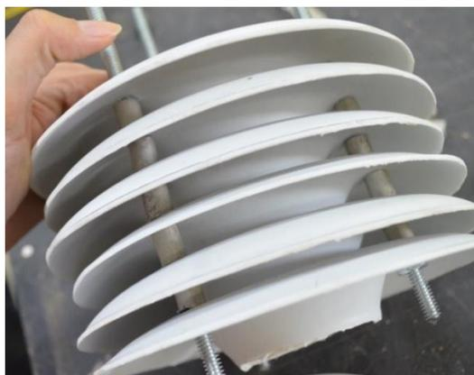
Figura 8 - Abrigo meteorológico montado.
