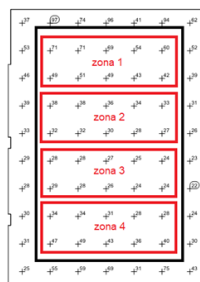
Figura 4 – Simulação no Dialux Evo 7.0 às 8h do dia 22/06: (A) Grelha de valores; (B) Distribuição de iluminância (AUTOR, 2023).
