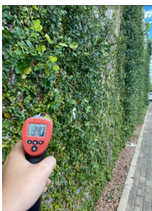
Figura 5: (A) Termômetro a laser Extech 42545 para os monitoramentos microclimáticos externos e internos.
