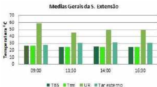
Figura 13- Dados coletados da sala de finanças. Sendo eles de temperatura de bulbo seco (TBS), temperatura radiante média (TRM), Umidade relativa (UR), temperatura do ambiente externo (Tar). (Fonte: autoria própria)
