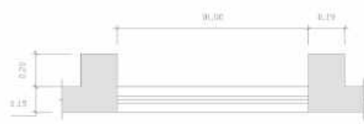
Figura 7 - Planta esquemática em dwg com destaque para configuração do brise vertical da FEM e suas dimensões (Fonte: Autoria própria)
