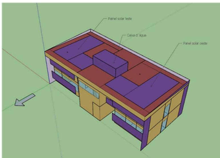
Figura 5 - Esquema da área disponível para uso dos painéis fotovoltaicos sobre a cobertura.
