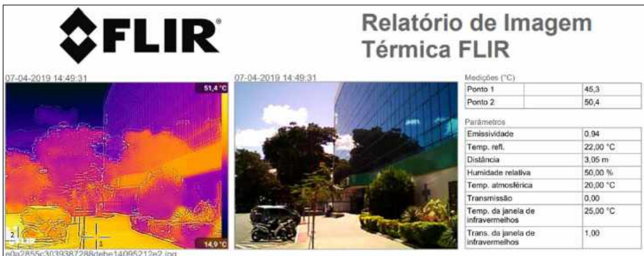
Figura 10 - Compilação de imagens da câmera termográfica da calçada e da via asfáltica (com medição pontual), bem como da imagem real do ambiente às 15h (07/04/2019).
