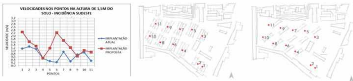
Fig. 13 Gráfico comparativo das velocidades nos pontos a uma altura 1,5 metros, na implantação atual e proposta, com vento incidente sudeste.
