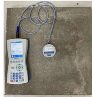
Figura 3 - Medição das propriedades térmicas na placa com incorporação de PET em 15%.
