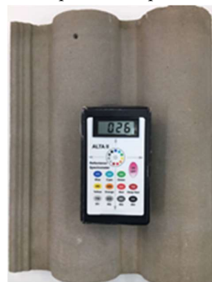
Figura 1 - Detalhe da medição da refletância com o aparelho Alta Reflectance Spectrometer
