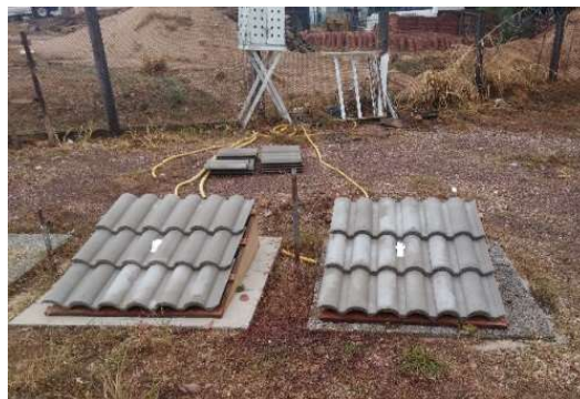
Figura 3 - Área do experimento com as TCs instaladas nos protótipos: TC REF (à esquerda) e PET15 (à direita)
