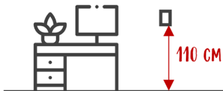
Figura 1 – Desenho esquemático apresentado aos participantes para posicionamento e fixação do datalogger Hobo
