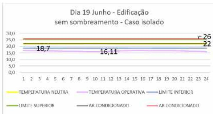
Figura 9 - Gráfico do dia de inverno sem sombreamento.
