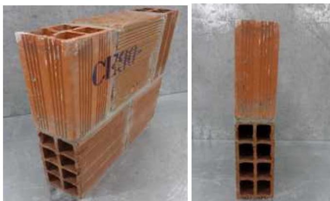
Figura 2 – Mini parede em tijolos cerâmicos (Autores)
