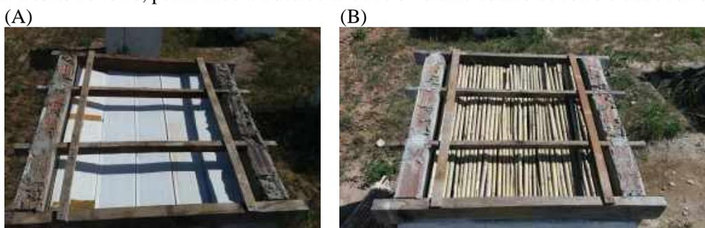
Figura 5 – Aplicação de forro de PVC rígido frisado branco (A) e de bambu *Guadua paniculata* (B) nas células-teste.
