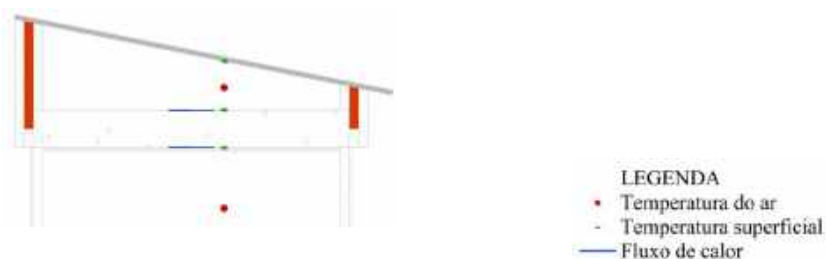
Figura 3: Posicionamento dos sensores nas coberturas com isolamento convencional e teto jardim
