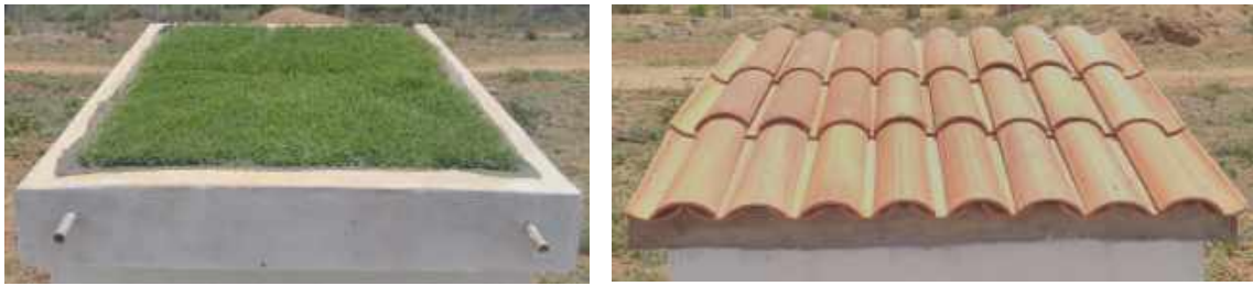
Figura 3 - (A) laje impermeabilizada com teto verde; (B) cobertura com telha cerâmica.
