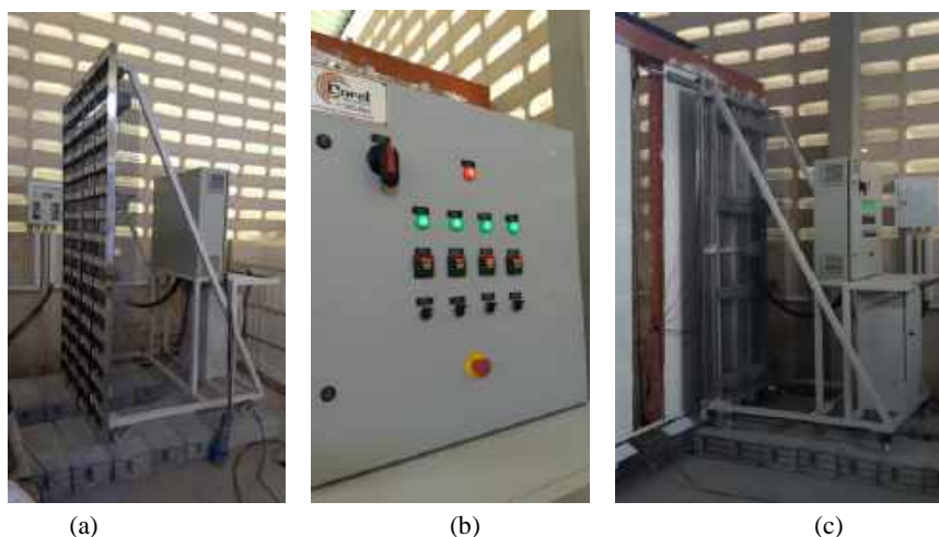
Figura 1 - Painel eletrônico irradiando calor para a alvenaria: (a) equipamento para realização do ensaio; (b) painel de controle; (c) equipamento posicionado de frente a alvenaria durante ensaio;.
