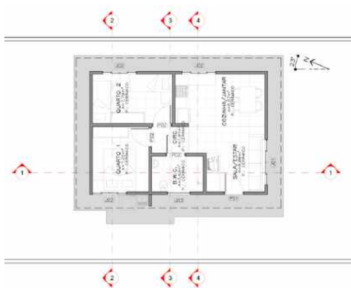
Figura 7 – Planta da HIS com os cortes estabelecidos para as análises (Fonte: acervo da Prefeitura Municipal de Maringá, 2012; adaptado pela autora, 2019).
