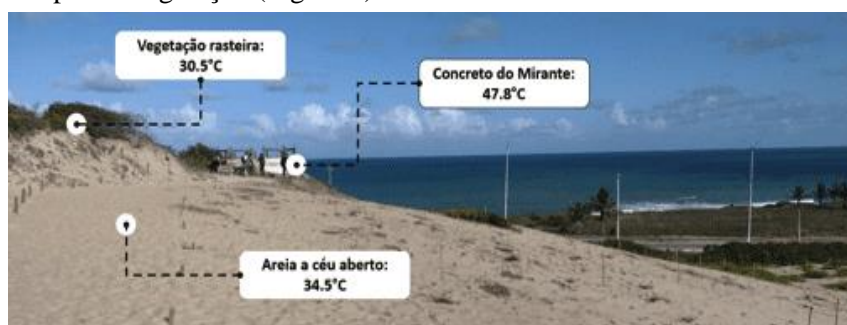
Figura 8 - Foto do Ponto de medição P1 com dados do termômetro de sensor infravermelho.
