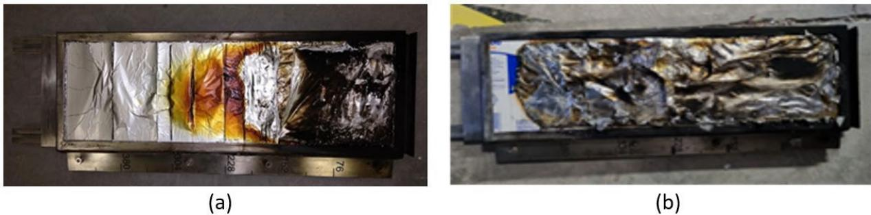
Figura 8: Amostras após o ensaio de painel radiante de parede: (a) com a face aluminizada aparente e (b) com papel cartão aparente.
