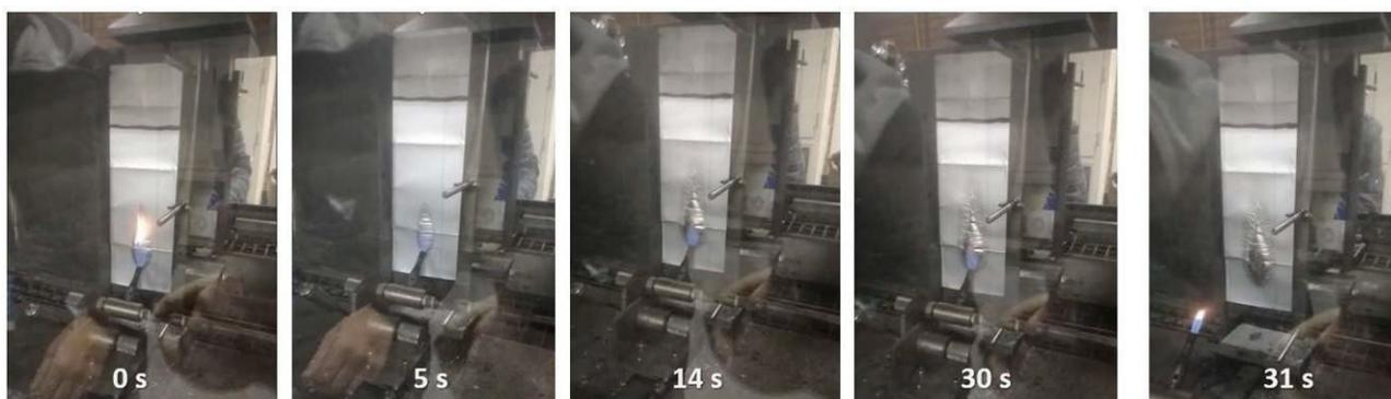
Figura 7: Andamento do ensaio de ignitabilidade com a incidência da chama na superfície da amostra.
