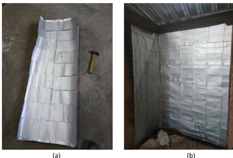
Figura 4: Ensaio de SBI: (a) união das embalagens e (b) corpo de prova instalado para o ensaio de SBI.
