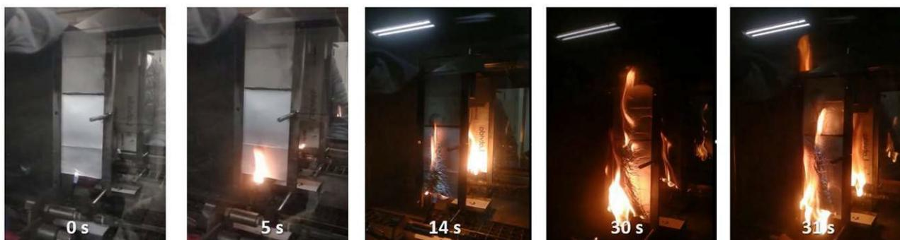
Figura 6: Andamento do ensaio de ignitabilidade com a incidência da chama na borda inferior.
