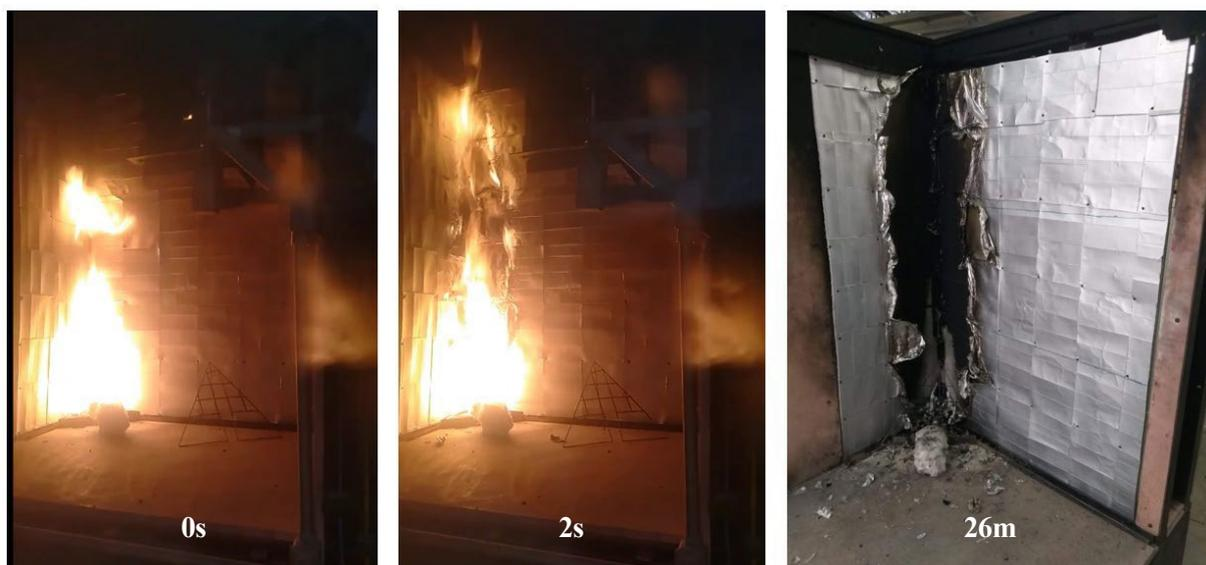
Figura 9: Amostra no ensaio de SBI: momento de ignição do queimador, após 2 segundo e no término do ensaio.
