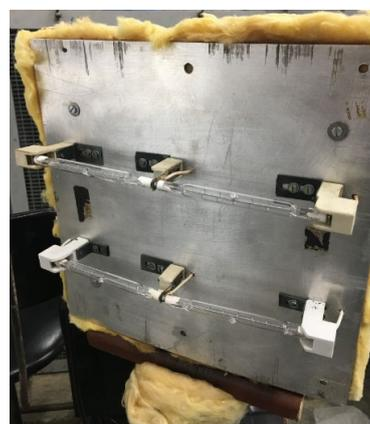
Figura 3 – Simulador solar com lâmpadas halógenas
