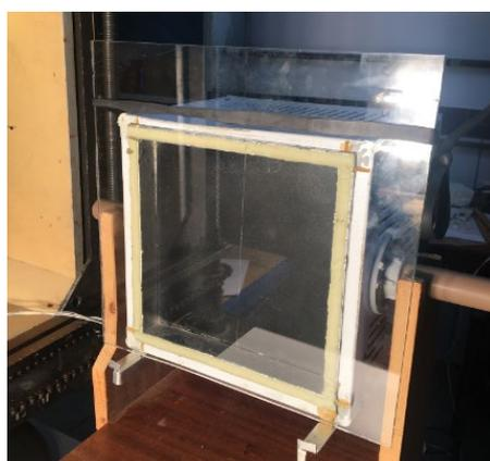
Figura 2 – Placa de vidro acoplada ao PoWEM.
