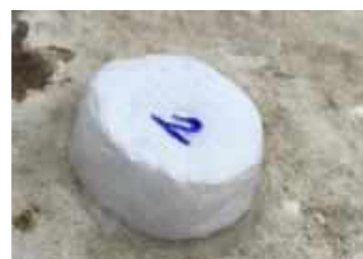
Figura 11: Sensor revestido por EPS e silicone na superfície externa da segunda guarita.
