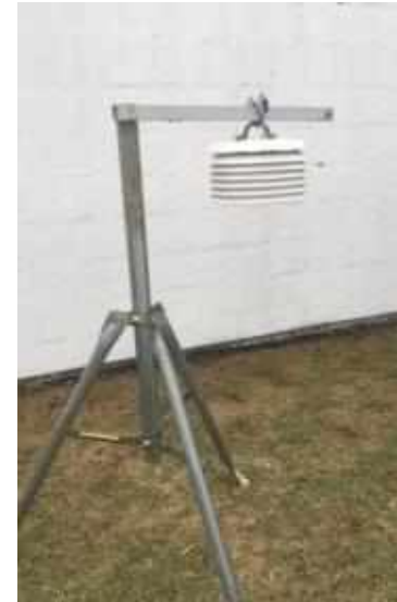
Figura 15: Sensor HOB0 situado no interior do abrigo suspenso pelo tripé.
