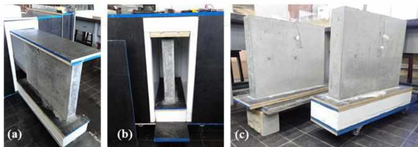
Figura 4 - Painéis levados para ensaio: (a) Painel sendo inserido na Câmara; (b) Painel funcionando como divisória na câmara; (c) P10 e P12. Fonte: Elaboração Própria.
