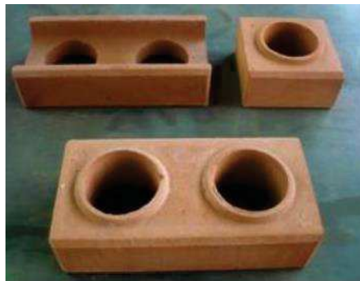
Figura 3 – Tijolos solo-cimento vazados utilizados na construção do protótipo.
