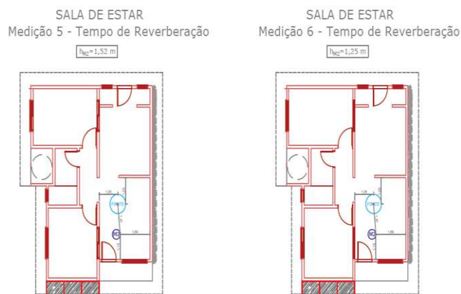
Figura 10 – Posicionamento de fonte e receptor para a medição do tempo de reverberação na sala de estar (TR).
