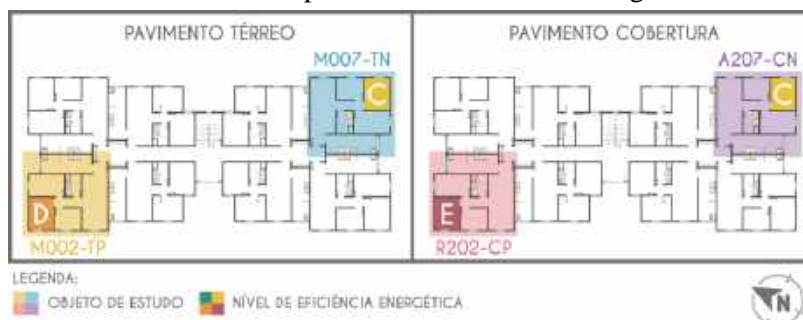
Figura 6 – Planta baixa com níveis de eficiência energética atingidos pelos ambientes.
