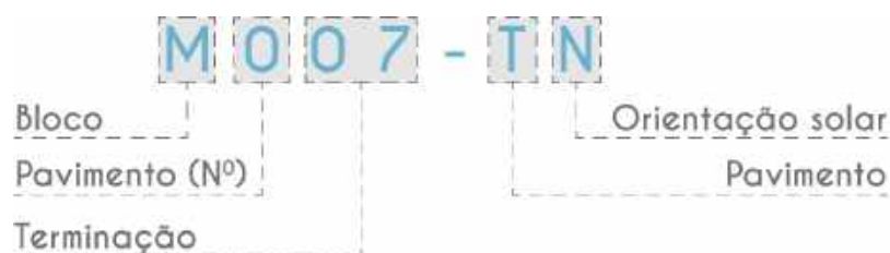
Figura 4 – Exemplo de aplicação da convenção adotada para a identificação das unidades habitacionais.
