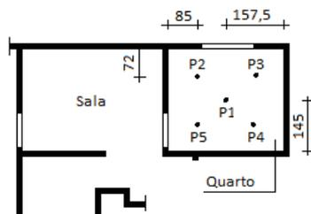
Figura 1 - Croqui de locação dos pontos de medição acústica nos quartos superior e inferior do EHBCM\_1, dentro da RMBH.
