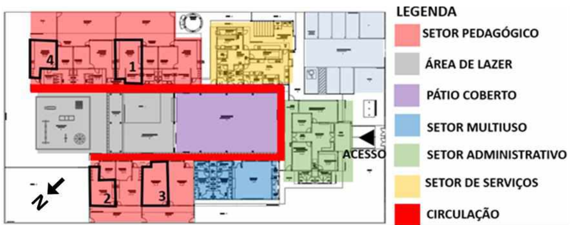
Figura 4 – Planta baixa do CMEI com setorização e localização das salas avaliadas (AUTORA, 2018).
