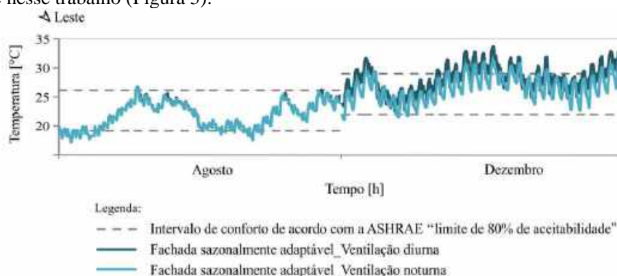
Figura 3 – Comportamento térmico mensal do modelo dotado de fachadas sazonalmente adaptáveis e diferentes condições de ventilação – orientação leste.
