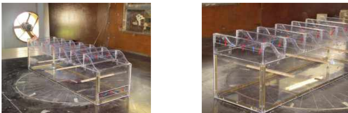
Figura 7 – Ensaios qualitativos com fios de lã dispostos na vertical no caso de referência
